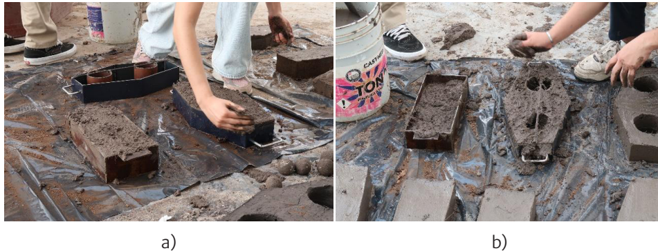
Figura 4. a) y b) Desarrollo de los diversos elementos constructivos con diversos tipos de tierra y dosificaciones. Tapia Placencia, 2025.
