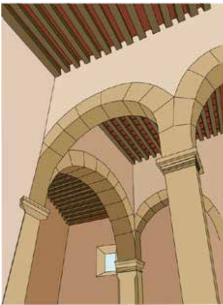
Figura 125. Cubiertas con vigas de madera y terrado en la capilla de Santa Ana Tepetitlán. Fuente: Elaboración propia, 2009.
