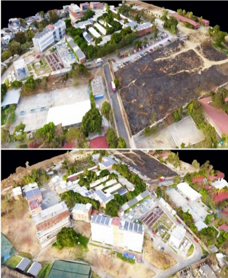
Figura 10. Vistas del conjunto en 3D de las instalaciones actuales y el nuevo terreno, generados con nubes de puntos obtenidos de las fotografías del dron
