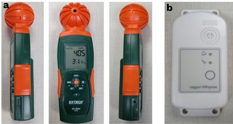
a. Monitoreo de calidad de aire interior ExTech CO240;
