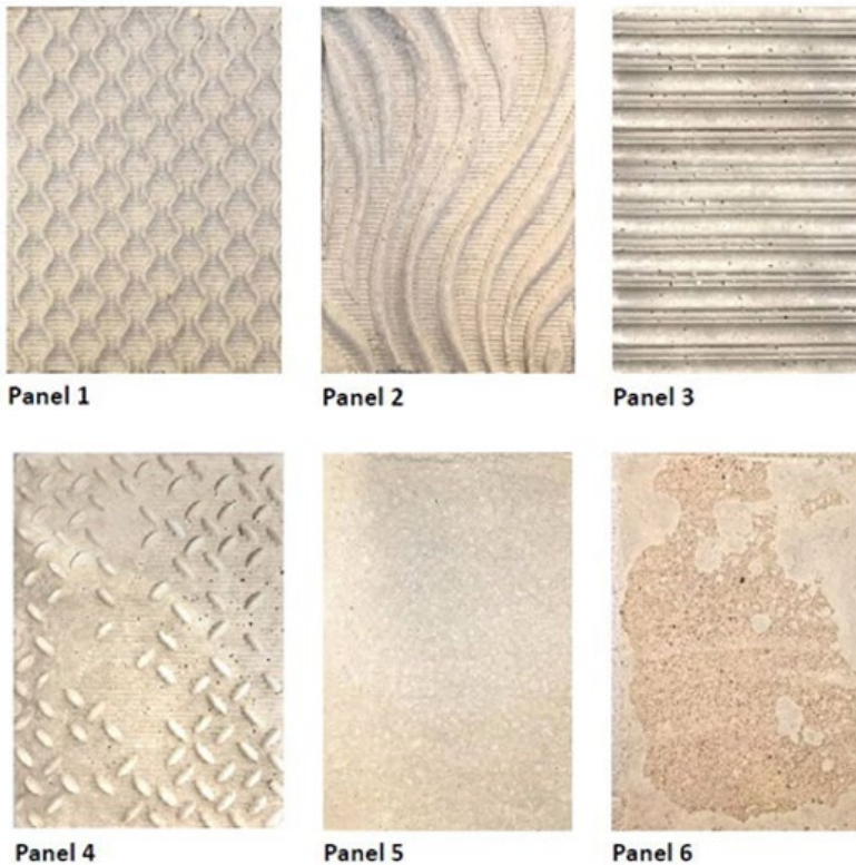
Figura 13. Prototipos desarrollados para la evaluación de distintas estrategias geométricas
