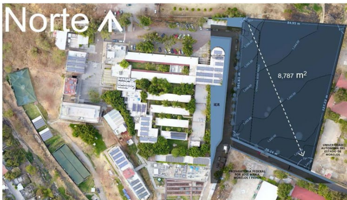
Figura 9. Niveles topográficos preliminares obtenidos con el dron a partir de la ortofotografía y la nube de puntos
