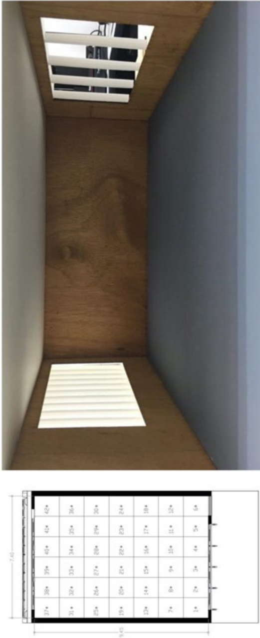
Figura 14. a) Retícula de análisis para el modelo a escala y el simulador (izq.); b) vista interior del modelo a escala, donde se aprecian los materiales con las reflectancias similares a las de la simulación numérica (der.)
